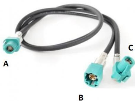
**Plug A** a un double câble, il doit être sur l'interface. Stightens **plug B** du câble vidéo sur la contre-prise du câble vidéo de l'unité multimédia.
